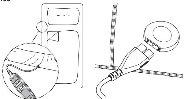
Затем натяните электрическую простыню на матрас со всех сторон, как натяжную простыню. Электрическая простыня рассчитана на использование с матрасами 90 x 200 см и 100 x 200 см. Если длины кабеля не хватает, то Вы можете дополнительно заказать более длинный кабель (арт. № 108.424) в сервисной службе. Затем закрепите свою натяжную про-
