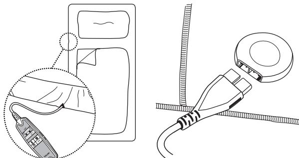
Tendere quindi la parte laterale sui lati del materasso, come un lenzuolo con gli angoli. Il coprimaterasso termico è concepito in modo da adattarsi a materassi da 90 x 200 cm e 100 x 200 cm. Se la lunghezza del cavo alimentatore dovesse risultare insufficiente, è possibile ordinare un cavo più lungo indicando il numero di catalogo 108.424 presso il nostro servizio assistenza
