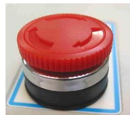
При повороте **кнопки аварийного отключения** по часовой стрелке, она со щелчком освобождается. Теперь привод может управляться пультом.
