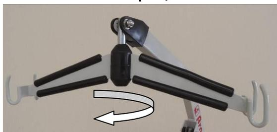
При подвешивании ремня **должны** использоваться все 4 крюка подъемного устройства так, чтобы нагрузка распределялась равномерно.
