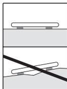
(RUS) Установить весы на прочную ровную поверхность.
