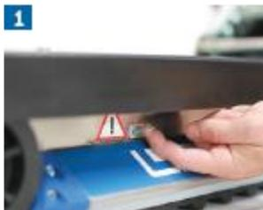
В случае непредвиденной поломки (технический дефект, проблема с питанием, отказ устройства и т.п.) система безопасности при поломках позволит оператору вручную спустить подъемник на лестничную площадку. Кабель системы безопасности располагается с левой стороны основного блока подъемника. Если Вы потяните кабель на себя электромагнитные тормоза разблокируются и подъемник под своим весом и весом Пользователя поедет вниз.
