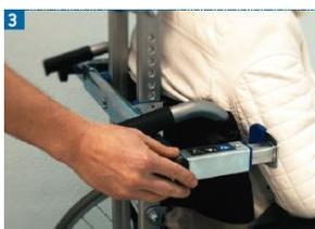
Установите кронштейн (удерживающий зажим) крепления кресла-коляски под изгибом ручки для толкания кресла-коляски. Потянув оба блокировочных штифта, Вы можете отрегулировать вертикальное положение кронштейна (по высоте кресла-коляски).
