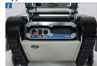
Основной блок работает при нажатии на кнопку «Включение/Выключение». После включения основной блок автоматически устанавливается в режим «Вверх». Повторное нажатие на кнопку «Включение/Выключение» переключает основной блок в режим «Вниз». Длительное нажатие на кнопку «Включение/Выключение» выключает основной блок. Используйте переключатель скорости, чтобы установить одну из трёх скоростей.
