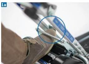
Разблокируйте ручку переместив фиксирующий рычаг. Перемещайте ручку по направлению к креслу-коляске до тех пор, пока ручка не примет почти вертикальное положение и колеса кресла-коляски не коснутся пола (ровной горизонтальной поверхности)
