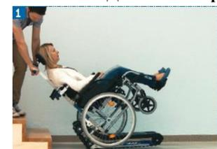
Движение по ровной горизонтальной поверхности производится при помощи колесиков подъемника. Нажмите на ручку подъемника для того, чтобы приподнять переднюю часть подъемника. Затем, при помощи колесиков подъемника, осуществите перемещение или маневрирование.
