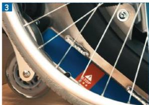
Остановите подъемник, как только пометки «Стоп», расположенные сбоку достигнут края верхней ступени. Затем постепенно наклоняйте подъемник назад до тех пор, пока гусеничные ленты не встанут на ровную горизонтальную поверхность. Снова нажмите под правой рукояткой кнопку «Включение»- подъемник прекратит движение. Движение по ровной поверхности производится при помощи колесиков подъемника
