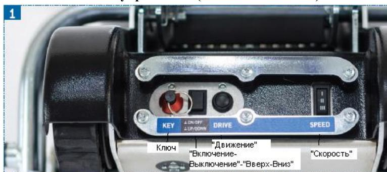
1. «Ключ» - защищает подъемник от несанкционированного использования.
