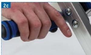
Встаньте сзади подъемника и нажмите под правой рукояткой кнопку «Включение». Движение по наклонной поверхности производится при помощи гусеничных лент.
