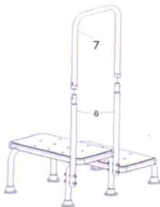
**Шаг 2:** Поместите U-образную трубу "7" в прямые трубки "6" до появления пружинного штифта в отверстии
