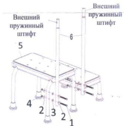
**Шаг 1:** Прикрепите две прямые трубки "6" к корпусу "5" с помощью винтов (как показано на рисунке), обратите внимание, чтобы пружинный штифт был повернут наружу. Используйте гаечный ключ, чтобы плотно закрутить гайку.
